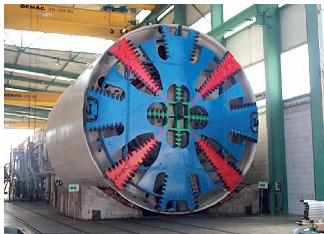
Obr. 4 – TBM použitý pro ražbu
